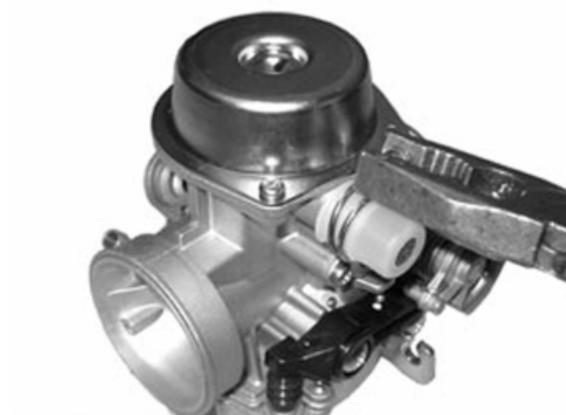
Rimuovere le 4 viti di fissaggio indicate in figura ed il coperchio della camera a depressione.
