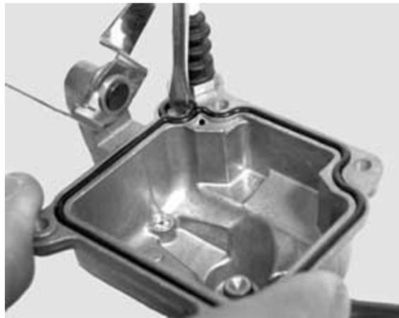
Supportare adeguatamente il carburatore e mediante spina e martello rimuovere il perno del galleggiante agendo dal lato comando gas.
